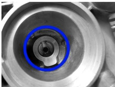
Das Ölfilterelement passt genau in die ausgefrästen Begrenzungen im Motorgehäuse. Das Ölfilterelement muss dabei mit einer Drehbewegung und ggf. mit leichtem Druck exakt eingesetzt werden.
