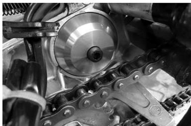
Den Ölfilteradapter mit der Schraube festziehen. Das optimale Anzugsmoment beträgt ca. 15Nm.
