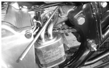
Die Kettenführung (341-17466-00) entfernen und die Antriebskette beim Kettenschloss öffnen.
