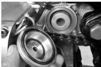
Der neue Ölfilter-Adapter mit beiden eingelegten O-Ringe auf das Ölfilterelement schieben und mit der mitgelieferten Schraube (M8 x 90) fixieren. Dabei ist darauf zu achten, dass die Kupferfing-Dichtung auf der Schraube platziert wurde.
