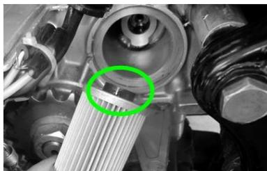
Der neue Ölfiltereinsatz kann nun mit der schwarzen Gummidichtung voran im Motorgehäuse eingesetzt werden. Vor dem Einsetzen das gelochte Schutzpapier entfernen.
